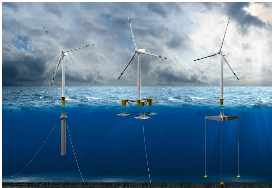
浮動式風機三大型式，依序為浮筒式(spar)、半潛式(semi-submersible)與張力腿式(Tension Leg)
