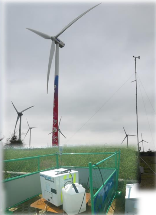
利用光達現址量測分析 風機發電效能
