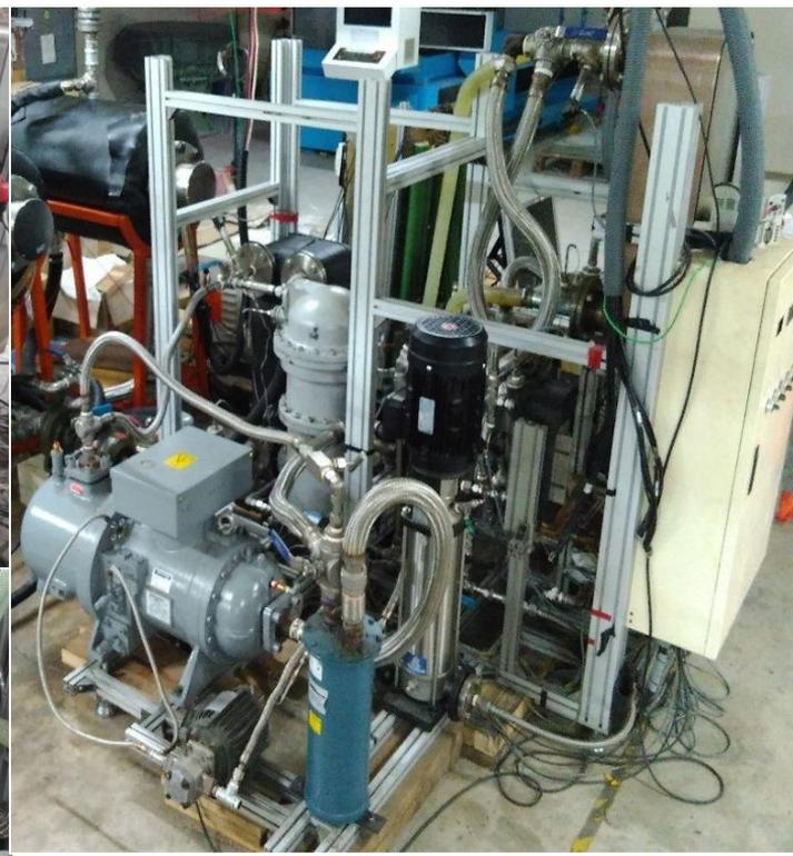
有機朗肯循環(ORC)是以常壓下低沸點之有機流體做為工作流體，在廢熱回收上之應用具有相當大的應用潛力。本計畫主要針對150°C以下廢熱回收之3kW與10kW動力輸出的ORC發電模組進行開發。3kW ORC機組以穩定、安全、持續性運轉為目標進行精進，且根據不同操作條件，如不同廢熱量、改變廢熱源流量等進行實驗分析。結果顯示操作之熱源範圍為15.8 kW至42.4 kW，其最佳淨熱電轉換效率為3.91%，產生2.1 kW的發電量。10kW ORC機組今年度計畫進度已超前，初步的實驗成果顯示在操作之熱源範圍為53 kW至113 kW下，最佳淨熱電效率為4.59%，最大發電量為6.32 kW，這些寶貴的實驗數據已發表了數篇國際知名的期刊並刊登，且受到國際的重視。雖然系統效率不高，但本研究已掌握了關鍵技術，並將精進開發為商業化產品。
