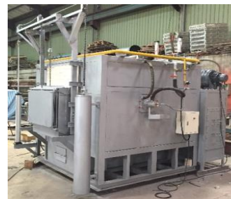
蓄熱式燃燒系統應用 精密鑄造產業燒結爐
