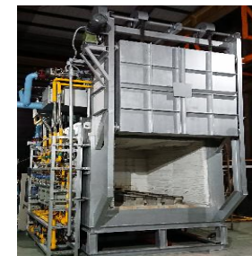
蓄熱式燃燒系統應用 金屬製品業固溶化爐
