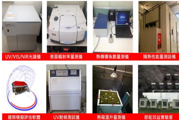
UV/VIS/NIR光譜儀 表面輻射率量測儀 熱傳導係數量測儀 隔熱性能量測設備
