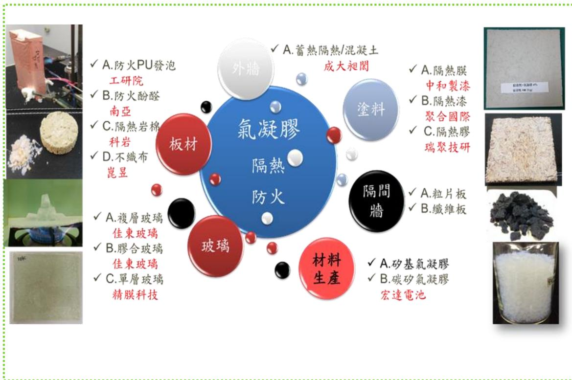
本團隊研發出三種氣凝膠製程：氣凝膠常壓乾燥製程(10公斤級)、次微米珍珠狀氣凝膠製程(料徑最小)、氣凝膠直接疏水化製程(成本最低)；並且建置「直接疏水化製程」每批次1公斤之實驗工廠，成本降至3000元/公斤。再者，以氣凝膠研發出防火隔熱效果優異之建材，如：結合相變化蓄熱材料並以水泥砂為介質，作為建築外殼防水節能塗層，並且以技轉給成大昶閣公司。高透光高隔熱膠合玻璃，具高透光高紅外線吸收可取代市場上low-E玻璃。子計畫主持人陳長仁教授於2016年榮獲C.B.T.I.A世界發明家大賞及第11屆台灣十大發明家殊榮。其團隊亦奪得2016台灣國際創新發明暨設計競賽銀牌獎。另研究論文：To improve the heat insulation efficacy of mineral wool by adding aerogel，獲得2016 ICASI國際研討會最佳論文獎。
