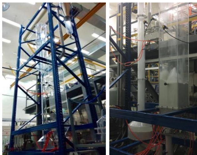
百kW th 級雙流體化床氣化爐冷模設施（左：整體、右：試驗過程）
