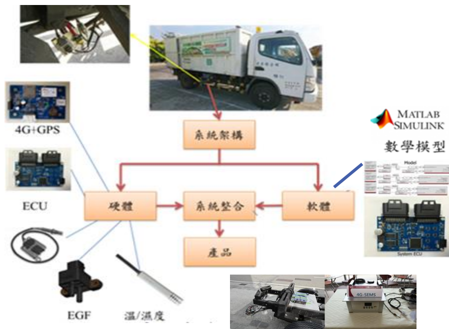
無線通訊簡易式污染量測系統架構與實體圖
